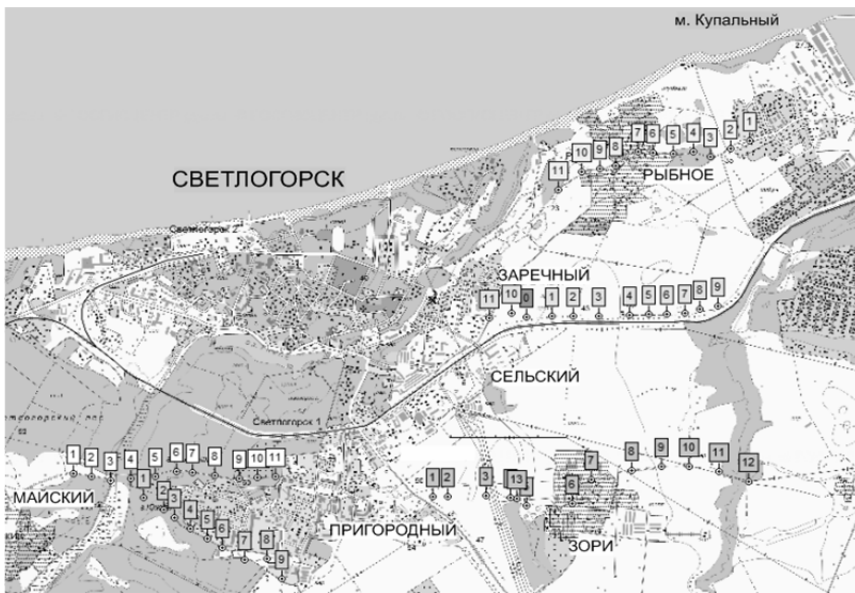
Рис. 3. Полевая опорная сеть (прямоугольниками показаны рядовые точки маршрутов, за «0» принят исходный опорный пункт)
